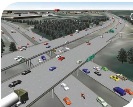
È possibile simulare il comportamento dei sistemi di trasporto complessi in ambiente GIS 2D o 3D per illustrare e valutare la dinamica dei flussi di traffico, dei sistemi semaforici e le prestazioni complessive della rete.
